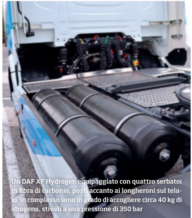
Un DAF XF Hydrogen equipaggiato con quattro serbatoi in fibra di carbonio, posti accanto ai longheroni sul telaio. In complesso sono in grado di accogliere circa 40 kg di idrogeno, stivati a una pressione di 350 bar
